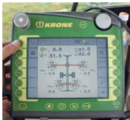
Das CCI-100-Terminal mit Touchscreen ermöglicht die Bedienung des Schwaders und anderer kompatibler Maschinen.
