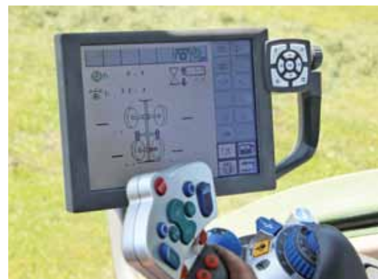
Die Premiumlösung ist die Bedienung des Swadro 1400 Plus über den Schlepperjoystick.
