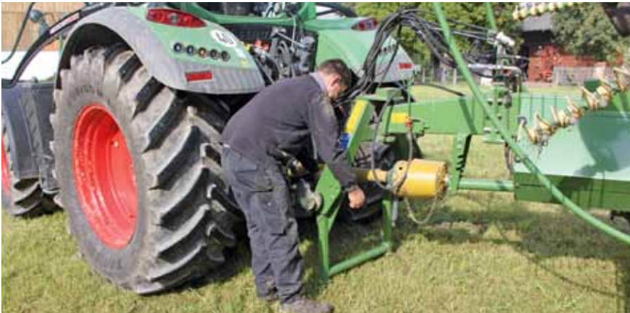
Der Anbau des Schwaders ist kein Problem. In wenigen Minuten ist die Maschine einsatzbereit. Dank der Anhängung in den Unterlenkern ist auch die Gelenkwelle bei versehentlichem Ausheben der EHR geschützt.
