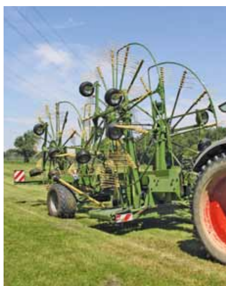
Um beim Transport unter 4 m zu bleiben, hat Krone dem neuen Swadro ein absenkbares Fahrwerk spendiert.
