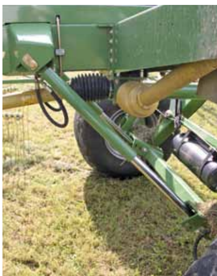
Verstärkte Antriebswellen mit 250 Stunden Wartungsintervall sorgen für problemloses Arbeiten bei großen Erntemengen.
