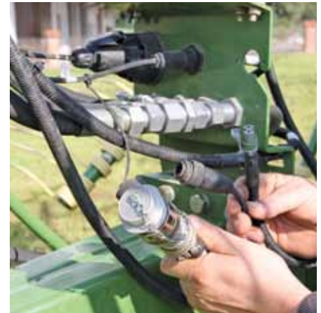
Für die Auswahl zwischen Schlepper oder CCI Terminal sind alle nötigen Stecker vorhanden.
