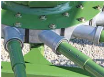
Die Zinkenträger-Lagergehäuse sind aus Aluminium. Das macht sie leicht und dennoch stabil.
