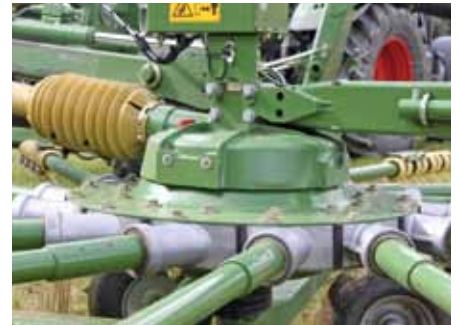
Kegelradgetriebe und Kurvenbahn sind komplett geschlossen und müssen nicht geschmiert werden.
