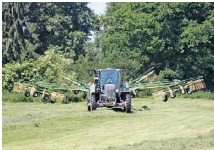
Die Aushubhöhe der Kreisel ist absolut ausreichend – das Überfahren von Schwaden ist problemlos möglich.
