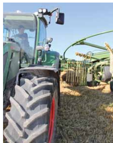
Vorsicht bei zu enger Kurvenfahrt: Wer ganz einlenkt, läuft Gefahr, den Reifen zu demolieren.
