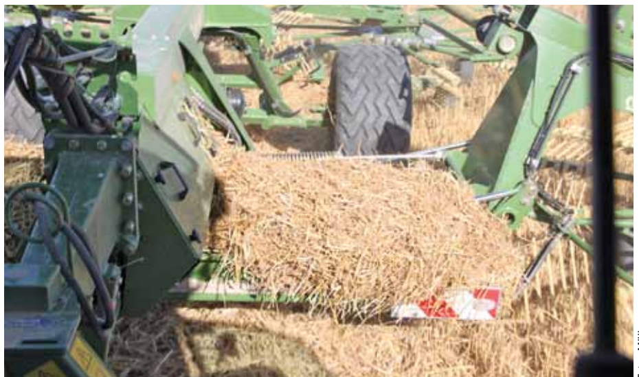
Vor allem bei Stroh hat sich eine ganze Menge an Erntegut auf dem vorderen Blech abgelagert.
