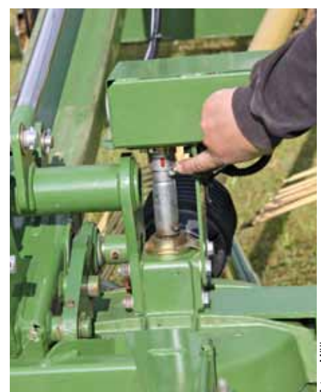
Über das Terminal kann die Arbeitshöhe mittels elektrischer Stellmotoren schnell und einfach verstellt werden.
